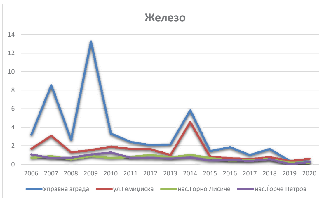
График 4. Просечната годишна концентрација на железо во аероседиментот во 2006-2020 година на четири мерни места во близина на скопските фабрики - Железара и Охис, како и во една индустриски загадена населба во Скопје (мг/м 2 /месец)
